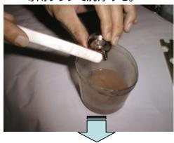
17mmのメガネレンチにて塗料 ノズルを外 し、専用ブラシにて洗浄する。
