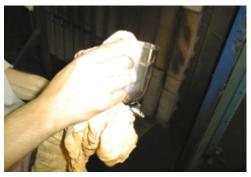
空気キャップを外 し 専用ブラシで洗浄する。
