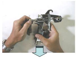
ニードル 弁バネとニードル 弁を手で後方に引き抜く
