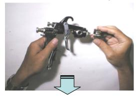
塗料調節ツマミを手で外す。 塗料調節ツマミを外すと ニードル弁バネも付いてくる。
